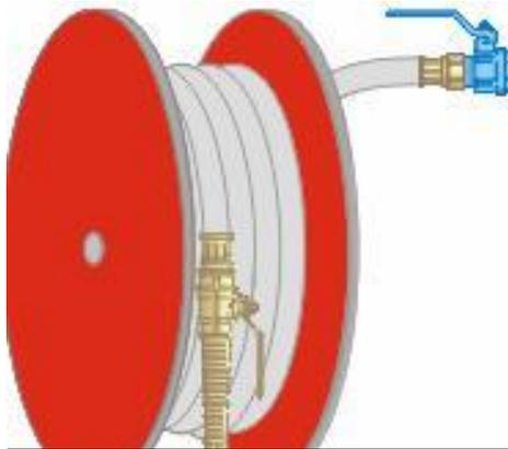
Le **principali attrezzature** per lo spegnimento degli incendi sono realizzate da tubature flessibili avvolte che collegano tubazioni **con acqua** in pressione ed erogatori capaci di lanciare l'acqua a distanza e perciò chiamati “lance” da incendio.
